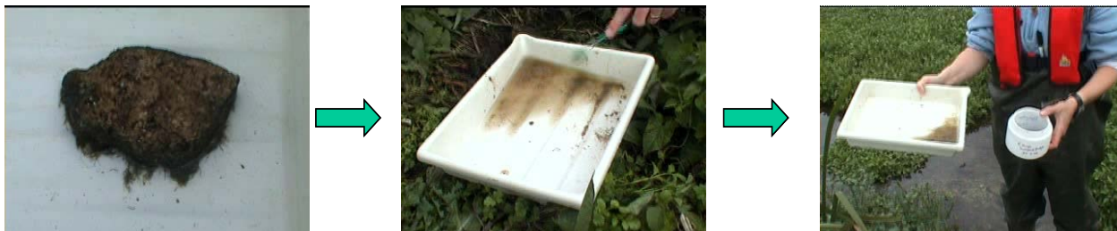
Figura 1- Sequenza delle operazioni in caso di campionamento di ciottoli.
